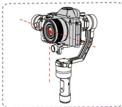
Отбалансируйте камеру, перемещая ее вперед или назад. Правильно отбалансированная камера не должна наклоняться под действием силы тяжести, когда ее объектив направлен вперед. Добившись баланса, затяните вращающуюся головку 4 .
